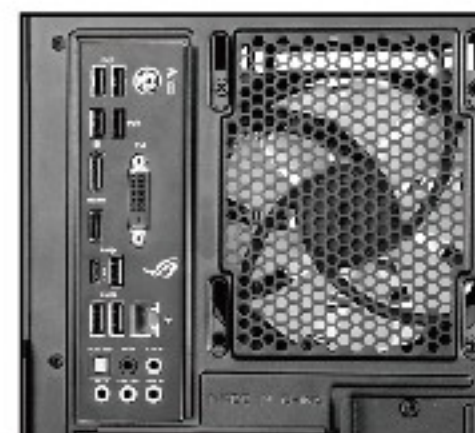
先將I/O封片卡入I/O孔
