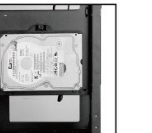
將鎖好硬碟的硬碟架鎖回主機板硬碟架位置
