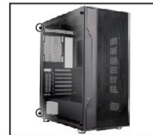
轉開後方螺絲，取下側板
