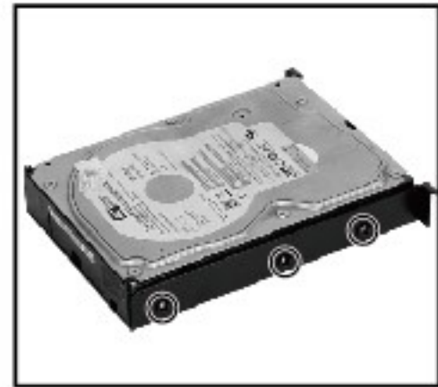
對準硬碟架兩側孔位所上硬碟螺絲固定硬碟架
