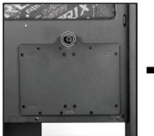
轉開螺絲取出主機板背部硬碟架
