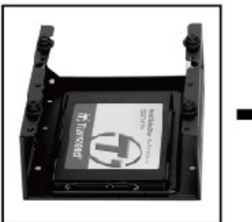
硬碟架內部放入SSD硬碟
