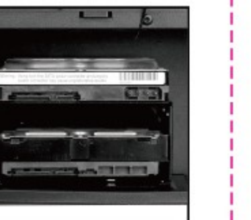
把鎖好硬碟的硬碟架安裝回底板
